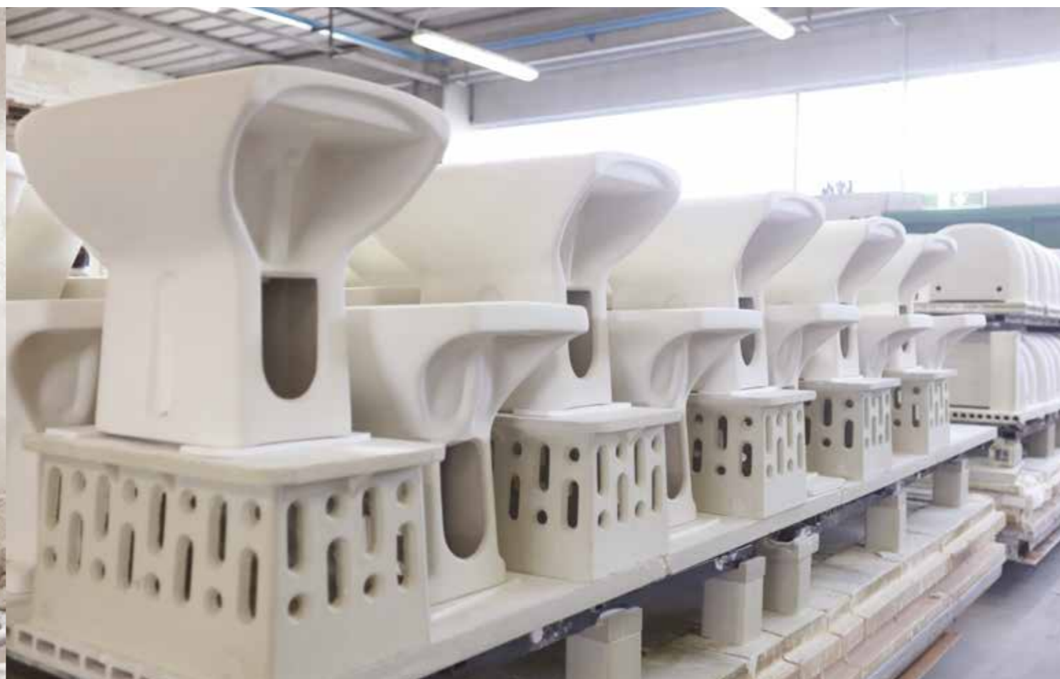
INGRESSO FORNO OVEN ENTRANCE
